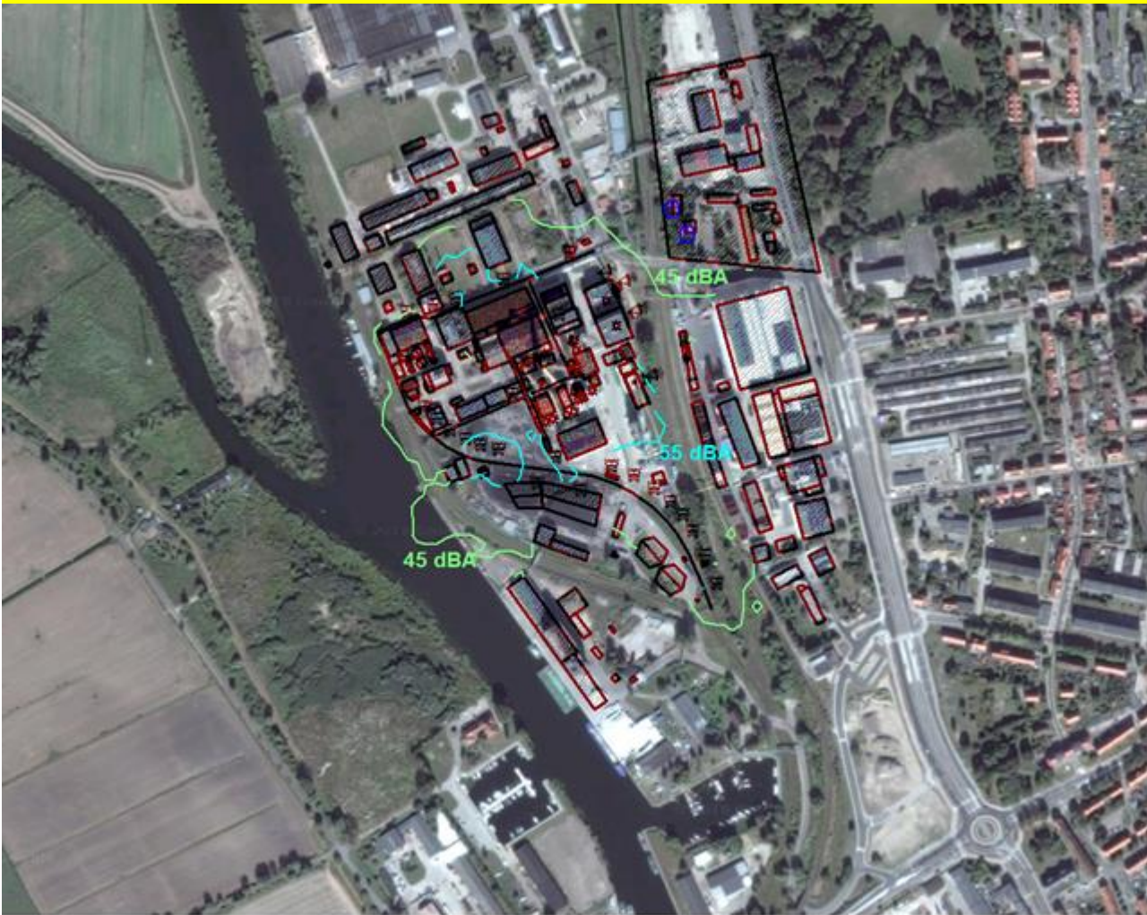
Rysunek 10 Poziom emisji hałasu z terenu Elektrociepłowni Elbląg z uwzględnieniem projektowanych instalacji SCR kotłów K5 i K6 oraz instalacji IOS - pora dnia i nocy
