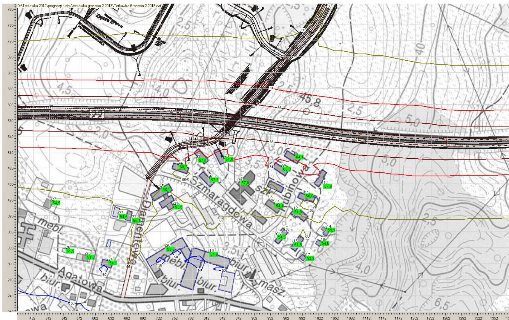
Rys. 22. Prognoza hałasu dla układu drogowego drogi krajowej nr 22 w otoczeniu obiektów mieszkaniowych w Gronowie Górnym w przedłużeniu ul. Diamentowej pora dnia rok 2019, poziom hałasu na obiektach wynosi ok. 51,5 – 64,1 dB, poza ww. obszarem dla ul. Diamentowej oraz ul. Agatowej wynosi 51,0 – 58,1 dB, norma 65 dB (zabudowa wielorodzinna) 61 dB (zabudowa jednorodzinna) dla pory dnia.
